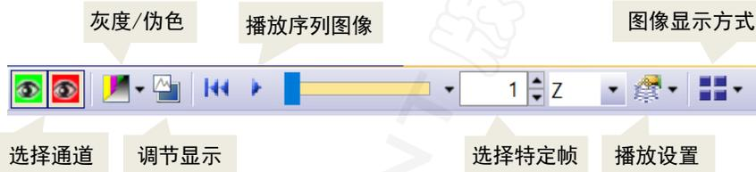
可以通过拖动区间或者直接输入数值, 定义图像显示灰度值的最大值和最小值。
